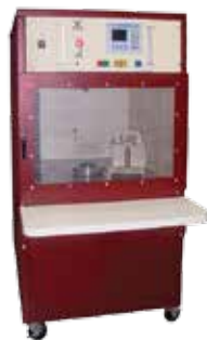
AC, 100 kV, ASTM D149
